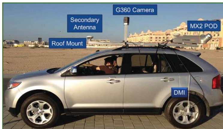
Рис. 2 Система Trimble MX2, установленная на автомобиле
